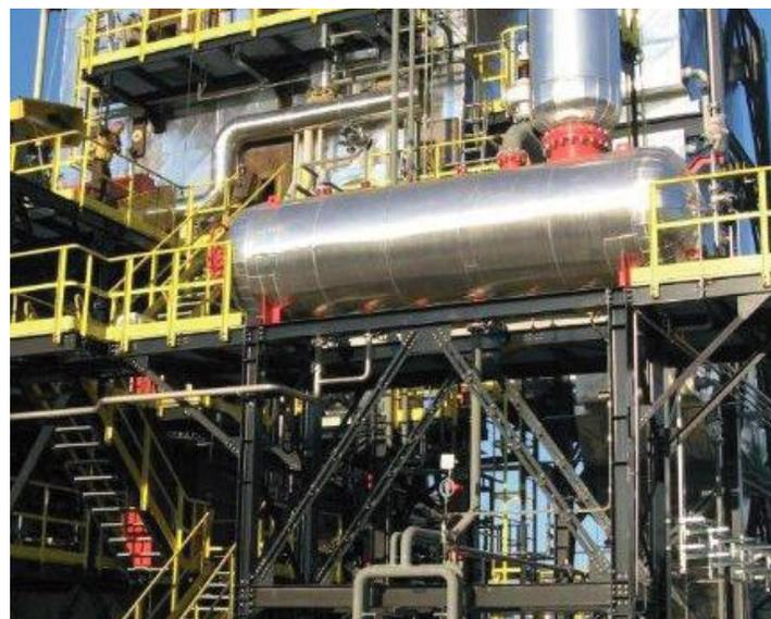
des méthaniseurs qui permettent de traiter des effluents liquides.
